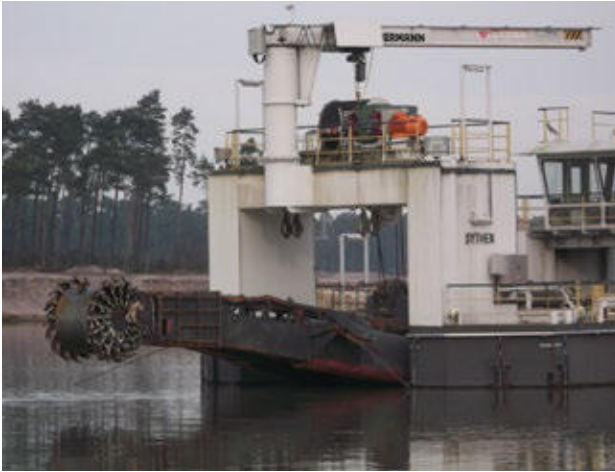
Bild 8.2 – Schneidrad-Saugbaggerschiff „Sythen“ im Tagebau Haltern-Sythen der Quarzwerke GmbH (Quelle: Matuszewski, Bezirksregierung Arnsberg)
